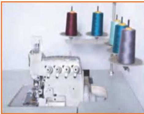
Fig:4.1.7: Five Thread Overlock Machine
